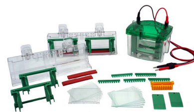
▲ 电泳以Bio-rad微型垂直电泳槽为例
